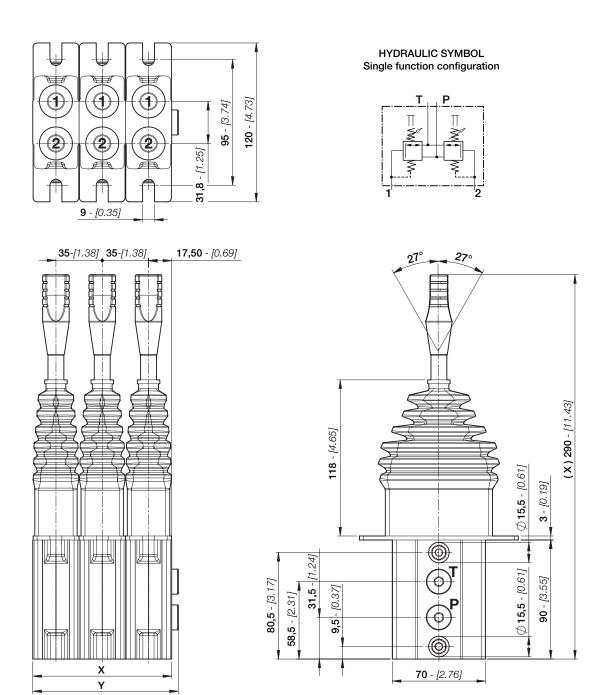
STANDARD CONNECTIONS FOR ESJ01A - ESJ01B - ESJ01C
